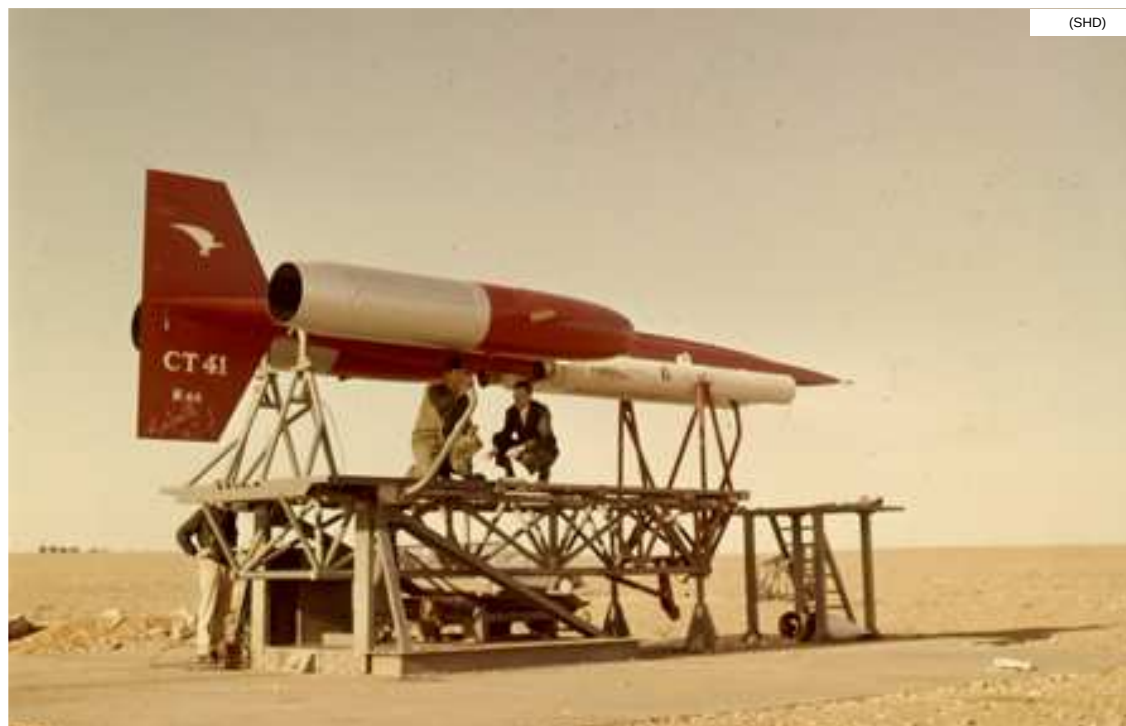
Engin cible hypersonique téléguidé Nord-Aviation CT 41 Narval équipé de deux fusées à poudre et de deux statoréacteurs
