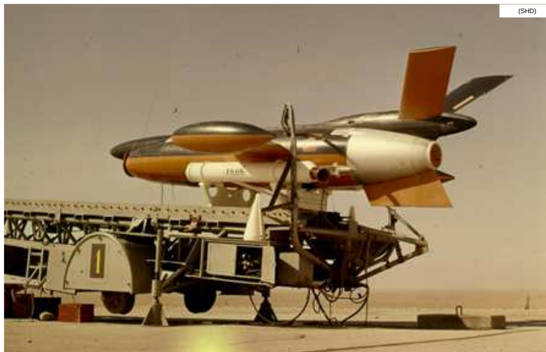
Engin cible téléguidé Nord-Aviation CT-20 (ex-Arsenal 5510) en mars 1960. Il est équipé d'un réacteur Turboméca Marboré
