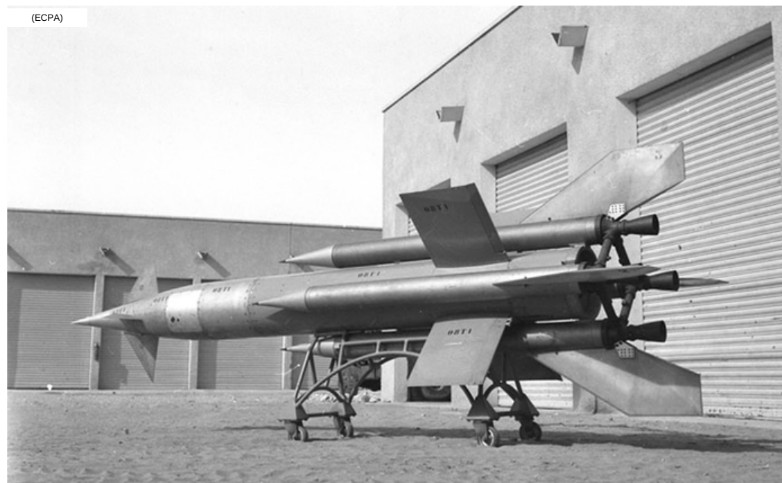
Missile antiaérien radioguidé à statoréacteur PARCA, en 1958
