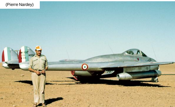
Mistral téléguidé, avec sa tuyère sous l'aile droite
