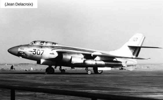
Vautour VIIN PP avec tuyère de prélèvement sous l'aile gauche
