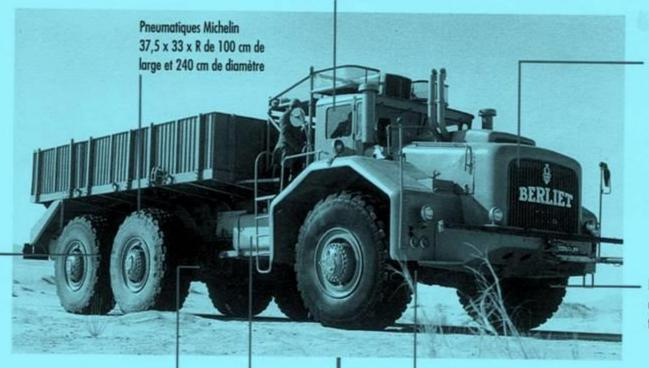
Moteur Cummins VT 12 de 30 litres de cylindrée développant 700 ch à 2 100 tr/mn
